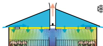
**Im Winter** - Durch einen erzeugten Unterdruck im Stall, wird die Frischluft über die Traufe in den Dachraum und durch die gedämmte, konstant offenporige Heraklith-Decke gleichmäßig und zugfrei dem Stallabteil zugeführt.
