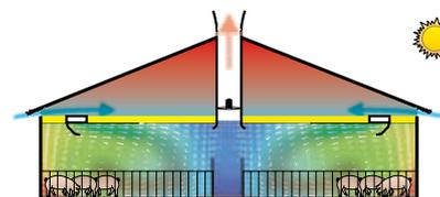
**Im Sommer** - In warmen Wetterperioden wird die Zuluft durch Deckenventile ergänzt. Durch eine angepasste Luftgeschwindigkeit wird damit ein kühlender Effekt zur Aufrechterhaltung einer optimalen Produktion etabliert.
